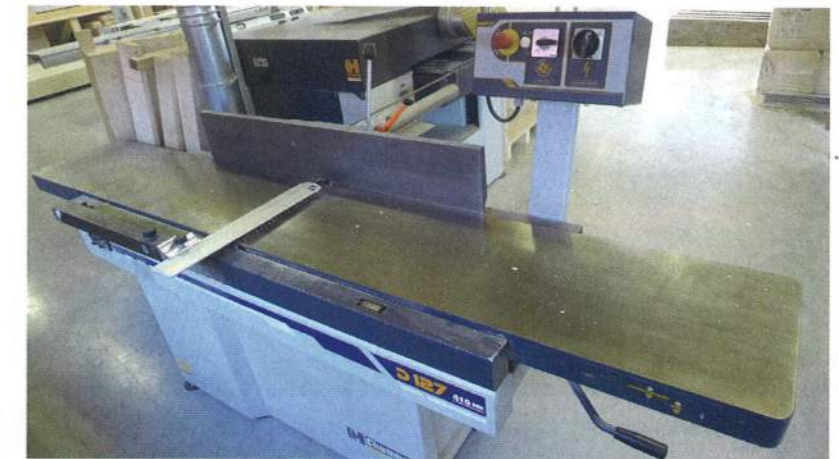
Le charpentier tourne avec une dégauchisseuse Chambron D127.
